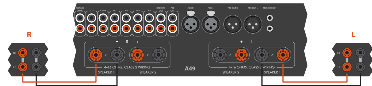
Усилитель A49 подключен к колонкам однопроводным соединением.
